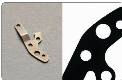
[ champ image : 6x4 | vitesse expo : 30 \mu s | focale : 10 ] [ distance travail : 100 mm ] [ distance objectif-BL & objectif-objet : 100 mm ]
